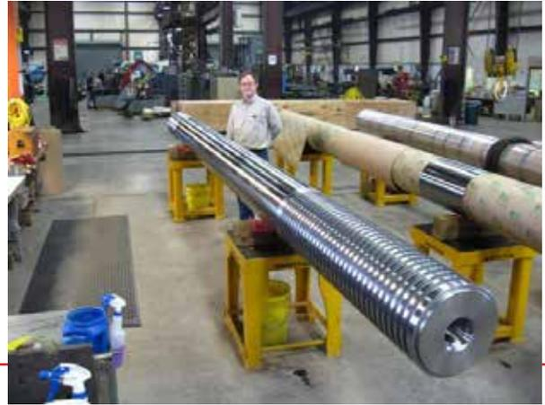
**Two-platen die cast tie bar**
